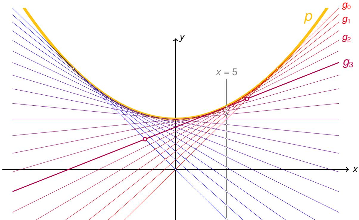
Zeichnet man die Schar von allen so definierten Geraden, so hüllen diese eine Kurve  $p$  ein. Diese Kurve nennt man **Hüllkurve** der Geradenschar.
